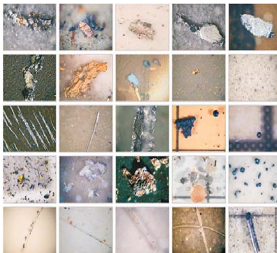
Рис. 7. Фотографии исследуемых мембран, сделанные при помощи микроскопа, – примеры частиц. Исследования по ГОСТ 17216 ИСО 4407
